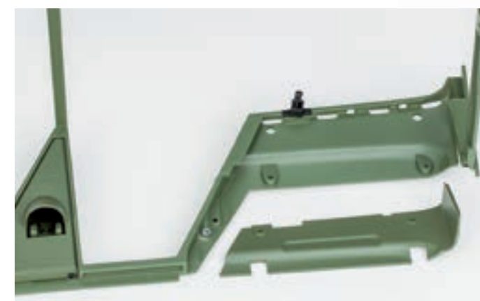
Шаг 3. С внутренней стороны каркаса кузова, в задней правой части, установите вставку панели багажника. Деталь должна плотно прилегать к поверхности каркаса.
