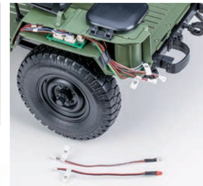
Шаг 1. Отсоедините провода с маркировкой E и G от шасси модели (провода со светодиодами заднего правого фонаря).
